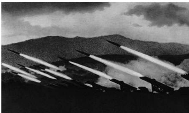
Это оружие по устройству относительно простое, состояло из направляющих рельсов и устройства их наведения. Ракета же представляла собой сварной цилиндр длиной 1,8 м и несла 22 кг взрывчатого вещества. Однако поражающее воздействие на
